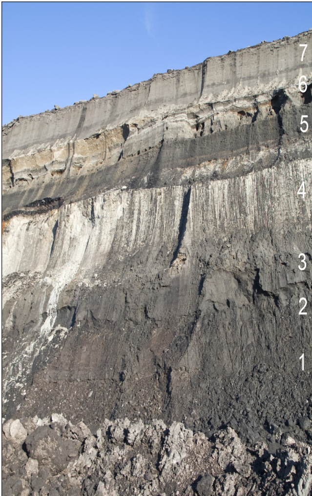
Abb. 6: Rupelbasis im nordwestlichen Bereich der Abbauwand in der Nähe von Teilprofil 3: 1 obereozäne Schluffe (Niveau Flöz Zöschen), 2 Transgressionshorizont 1 (TR1) und mariner Basissand (3), 4 helle Schluffe/Tone mit Oberflöz 1 (Flöz Lochau) am Top (5), 6 Transgressionshorizont 2 (TR2) und 7 marine Sande. Im Bereich des Planums (über der Ziffer 7) sind Reste des ersten Schluffhorizonts (UT01) zu erkennen. Dieses Teilprofil zeigt die Normalausbildung in weiten Teilen des Tagebaus, wie sie auch von BLUMENSTENGEL & WELLE (1996) angegeben wurde.
