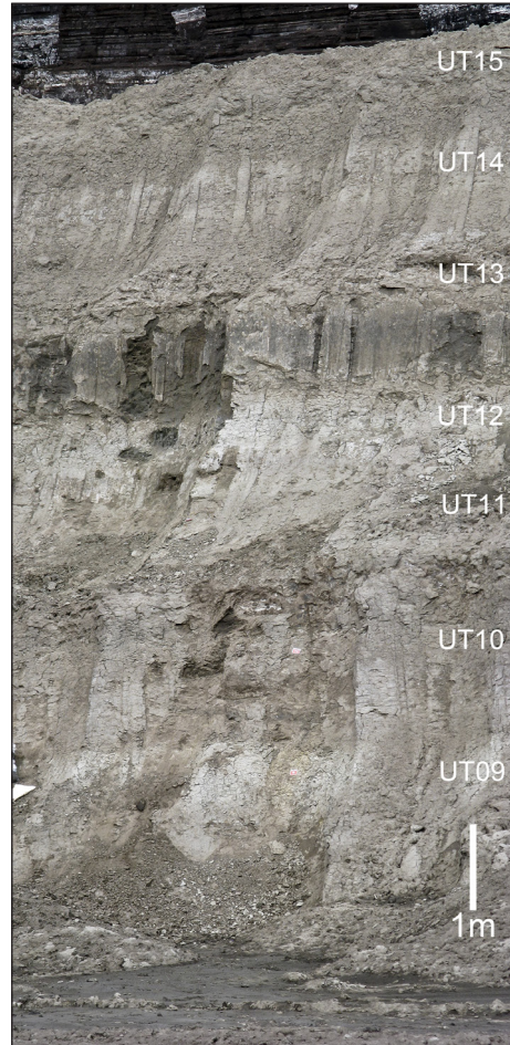
Abb. 21: Profilanschnitt bei Teilprofil 4 mit den Ton-/Schluffbänken UT09–UT15.
