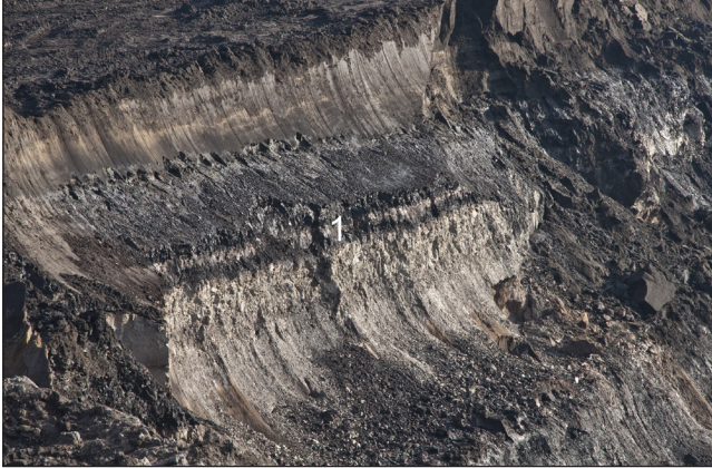
Abb. 5: Blick auf einen Ausschnitt der nordöstlichen Abbauwand (unmittelbar neben Teilprofil 1) mit obereozäner Schichtenfolge. 1 markiert den Bereich der Oberflöze (Oberflöz 2. 1 oder Flöz Schkeuditz).
